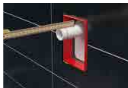
6. Obeležiti dužinu od 3 cm na navoju, mereno od zida odnosno pločice.
